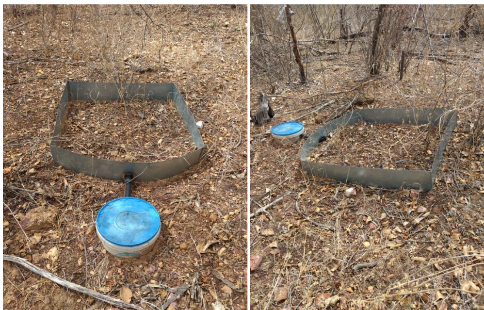
Figura 2. Calha de monitoramento do escoamento superficial
