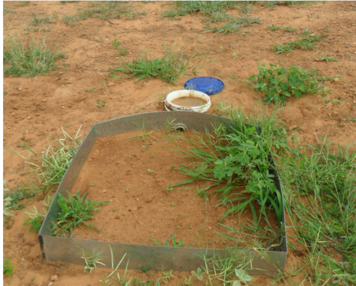
Figura 5. Calha de monitoramento do escoamento superficial. Foto: 31/05/2013.
