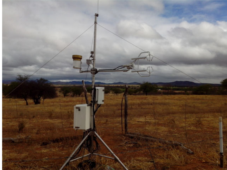
Figura 2. Instrumentação e torre micrometeorológica instalada na pastagem. Foto: 12/10/2013.
