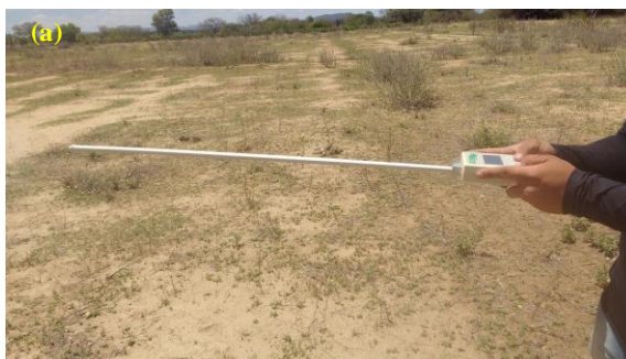
Figura 3.6 - Sensor de radiação linear fotossinteticamente ativa (PAR), AccuPAR (modelo LP-80) utilizado na área com indícios de desertificação (AID) para a mensuração acima (a) e abaixo (b) do dossel.
