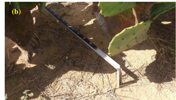
Figura 3.5 - Sensor PAR linear, instalado abaixo do dossel (SQ-321 Calibration Line Quantum Net10 sensors, Apogee, Logan, Utah, USA) próximo às plantas (RFALI, \text{MJ m}^{-2} \text{d}^{-1} ) utilizados na área de agroecossistema de cactáceas (AAC) após o corte (a) e antes do corte (b).
