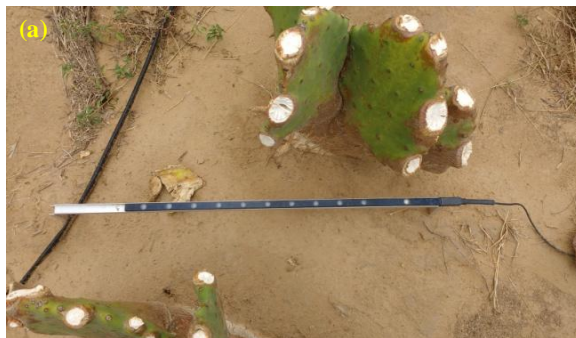
Figura 3.5 - Sensor PAR linear, instalado abaixo do dossel (SQ-321 Calibration Line Quantum Net10 sensors, Apogee, Logan, Utah, USA) próximo às plantas (RFALI, \text{MJ m}^{-2} \text{d}^{-1} ) utilizados na área de agroecossistema de cactáceas (AAC) após o corte (a) e antes do corte (b).
