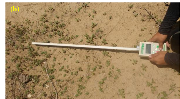
Figura 3.6 - Sensor de radiação linear fotossinteticamente ativa (PAR), AccuPAR (modelo LP-80) utilizado na área com indícios de desertificação (AID) para a mensuração acima (a) e abaixo (b) do dossel.
