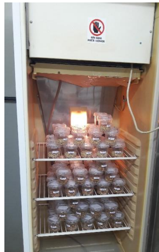
Fig. 3. Montagem do Teste sem chance de escolha sob condições controladas (temperatura 27 \pm 2^\circ \text{C} , umidade relativa 70 \pm 10\% e fotofase = 12 horas) em câmaras climáticas tipo B.O.D.
