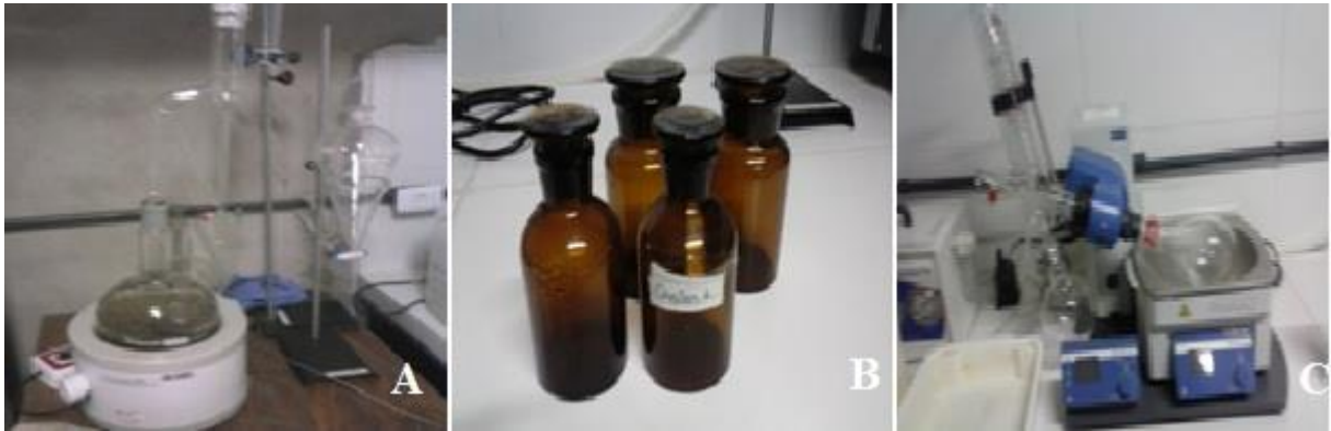
Figura 2- Processo de extração de óleos essenciais no aparelho Clevenger (A), armazenamento em potes de cor âmbar (B) e purificação dos óleos em Evaporador Rotativo (C). Fonte: Brito (2015).
