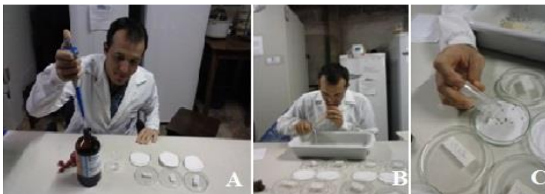
Figura 6- Montagem do teste de contato: (A) coletando acetona; (B) liberando os insetos no centro do papel tratado e (C) placas armazenadas em estufa tipo B.O.D. Fonte: Brito (2015).
