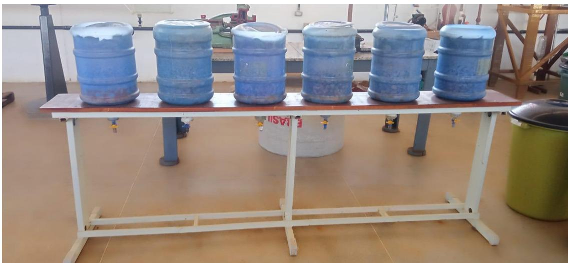
**Figura 2.** Bancada de filtros físicos para tratamento de água cinza – Laboratório de hidráulica – Serra Talhada – dezembro de 2023.
